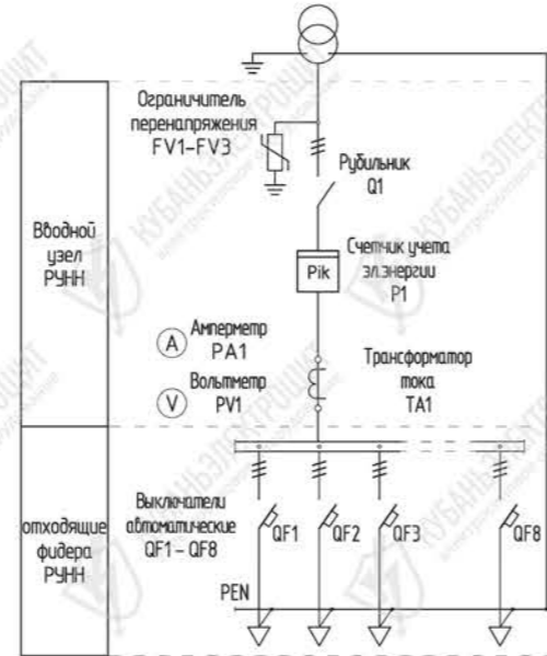
Схема РУНН №02 для КТП с внутренней ячейкой.
